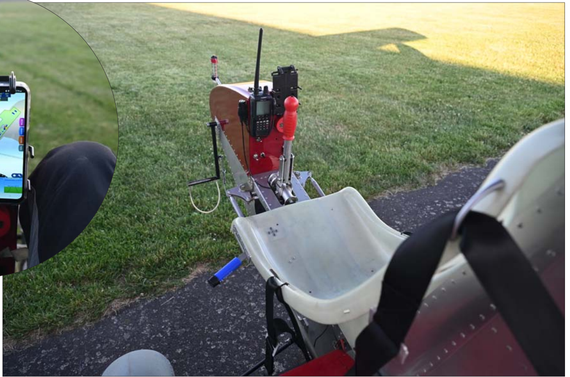
“仪表蘑菇”：紧凑，但包含所有飞行、导航和通信所需的设备。
