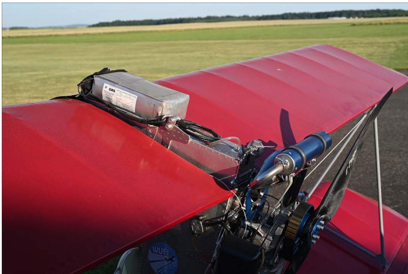
Dingo 配备的 GRS 3/180 整机伞系统，可在水平飞行状态下，在 40 米高度以 60 公里 / 小时的速度安全启动。
